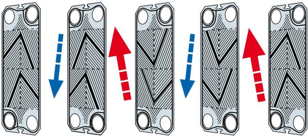
Принцип асимметрии, используемый в конструкции пластин Ультрафлекс позволяет добиваться максимальной оптимизации коэффициентов теплопередачи каждого контура.
