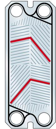
Путем комбинирования направлений и рельефов пластин конструкции Ультрафлекс с тупым или острым углом достигается шесть различных конфигураций, что позволяет выполнять поставленные Вами технические задачи.
