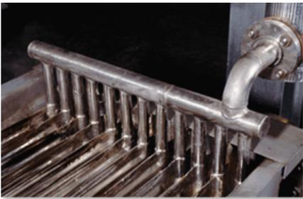
Для погружного нагрева плоские формы PLATECOIL создают эффект тяги для естественной конвекционной циркуляции и повышенной равномерности нагрева.
