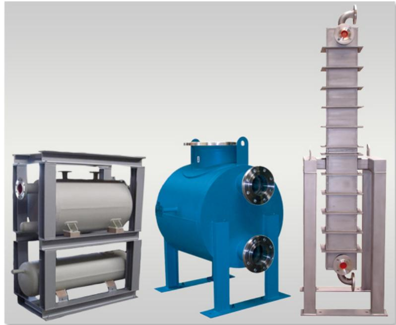
Примеры универсальности кожухо-пластинчатых теплообменников (слева направо): R404a- DX-cascade с круглыми пластинами с коллектором CO<sub>2</sub>, конденсатор во внутренней зоне с большим расходом и теплообменник два-в-одном с овальными пластинами с повышенной длиной нагретого участка, устанавливаемый в установках для обезвоживания газа.
